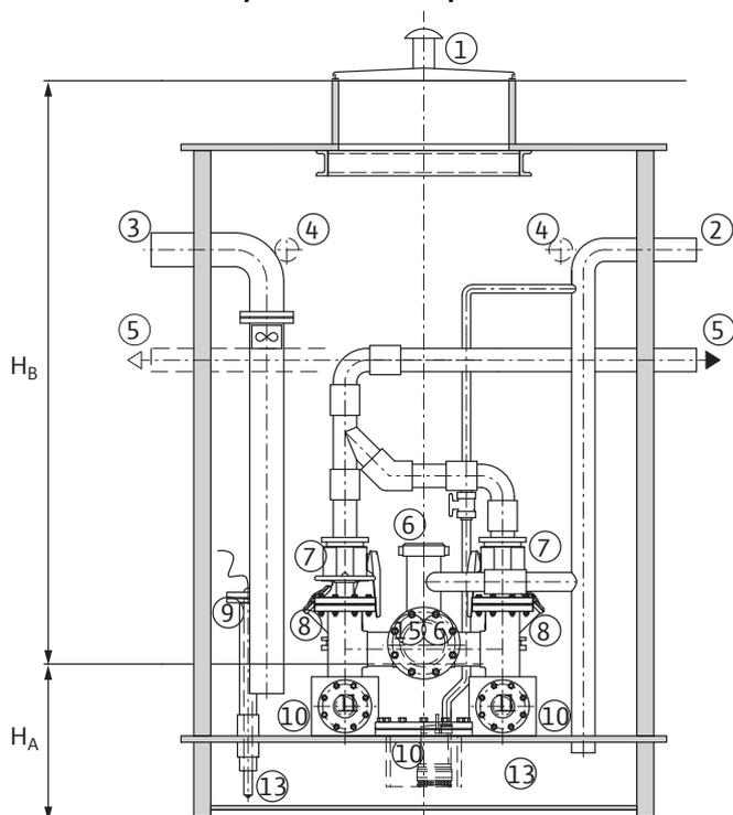
1 = крышка шахты 2 = вентиляция резервуара; 3 = вентиляция шахты;
